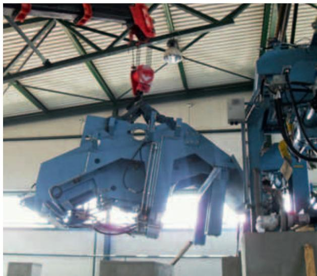
Производительность станка — до 52 м<sup>3</sup> щепы в час длиной 15–25 мм.
